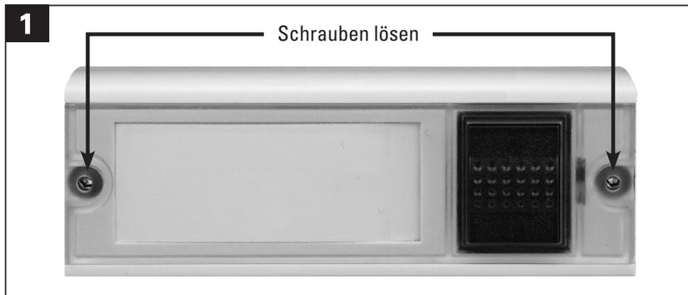
Sie müssen zunächst das **Oberteil** des Funkklingeltasters **abnehmen**, um die **Batterien einzusetzen**, das **Namensschild zu beschriften** und um den Funkklingeltaster **mit den Schrauben zu montieren**. Lösen Sie dafür die Schrauben in der Abdeckung mit dem beiliegenden Innensechskantschlüssel.
