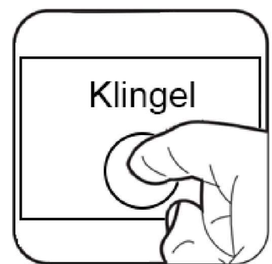
Klingelknopf innerhalb von 5 Sekunden betätigen, um Funkgong anzulernen.
